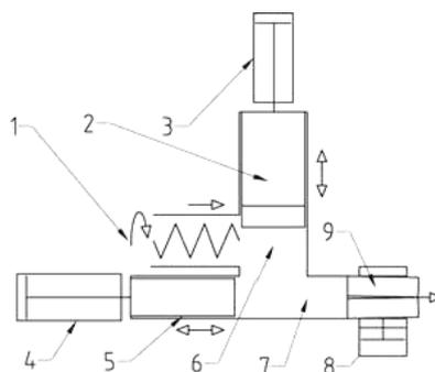
Fig. 1. Scheme of a hydraulic briquette press
